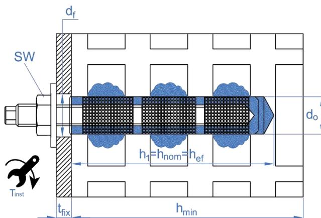
Para realizar fijaciones en ladrillos huecos se deberá usar un tamiz plástico para evitar que la resina se caiga por los agujeros interiores. En determinados casos para realizar fijaciones en ladrillo en las que se desee roscar un perno se puede utilizar un tamiz metálico con rosca interna para realizar la fijación. En ese caso, el tamiz metálico con rosca interna, deberá ir dentro de un tamiz plástico
